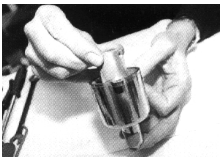
17. Píst testujeme tak, že ucpeme převodní (transferrní) díry v pístu a měříme rychlost, s jakou píst sjede lehce naolejovanou sací komorou
