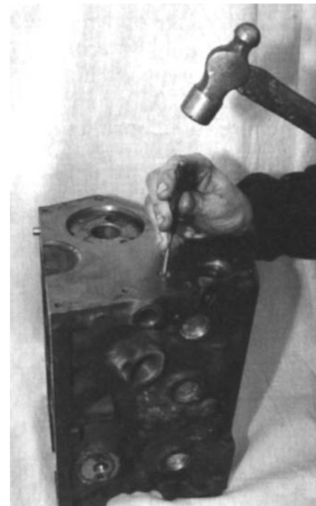
Nemusíte řezat závity v olejových kanálech a na závitových zátkách po pročištění. Nové mosazné zátky perfektně postačí
