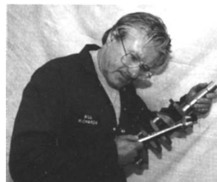
Poslechněte si zvonění kliky. Nízký tón znamená kliku z EN 16, vysoký tón je klika z oceli vyšší třídy
