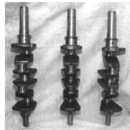
Nevyhazujte standardní kliku (vlevo), pokud nepotřebujete kliku EN 40B (uprostřed) nebo kliku z jednoho kusu (vpravo) pro trvale vysoké zatížení
