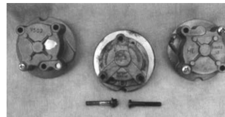
Nahraďte standardní olejové čerpadlo (vlevo) typem s ocelovou zadní stěnou pro bloky s malým vrtáním (uprostřed) nebo verzí Metro Turbo (vpravo)
