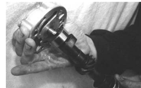
Náhon olejového čerpadla musí snadno zapadnout do zakončení vačkového hřídele. Rozvážně použití pilníku zmírní všechny drsnosti nebo vady
