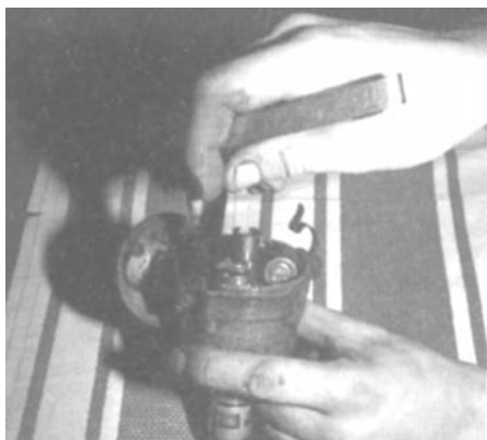
Používejte rozdělovač s asymetrickou vačkou a kontrolujte její opotřebenění na všech čtyřech vrcholech vačky
