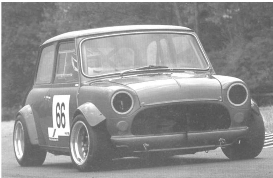
Tento okruhový Mini je extrémně nízko a má seřizovatelná spodní ramena pro nastavení negativního odklonu přední nápravy. Je to skvělé pro rovné, hladké okruhy, ale odskok při zatáčení je velmi silný. Citlivé řízení tohoto auta je pro normální silniční provoz nepoužitelné
