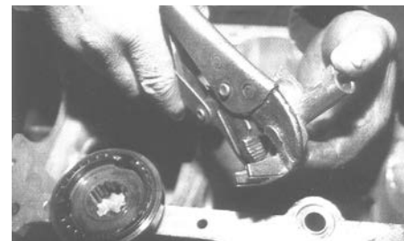
Pokud má řadící vidlička přílišnou vůli, seřídte ji samosvornými kleštěmi
