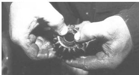
Mosazné futro kolečka zpátečky musíte vyměnit, pokud s ním dokážete prsty pohnout
