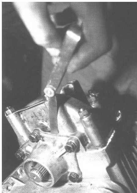
Diferenciál musíte vypodložit (jak naznačeno) přesně podle dilenského manuálu
