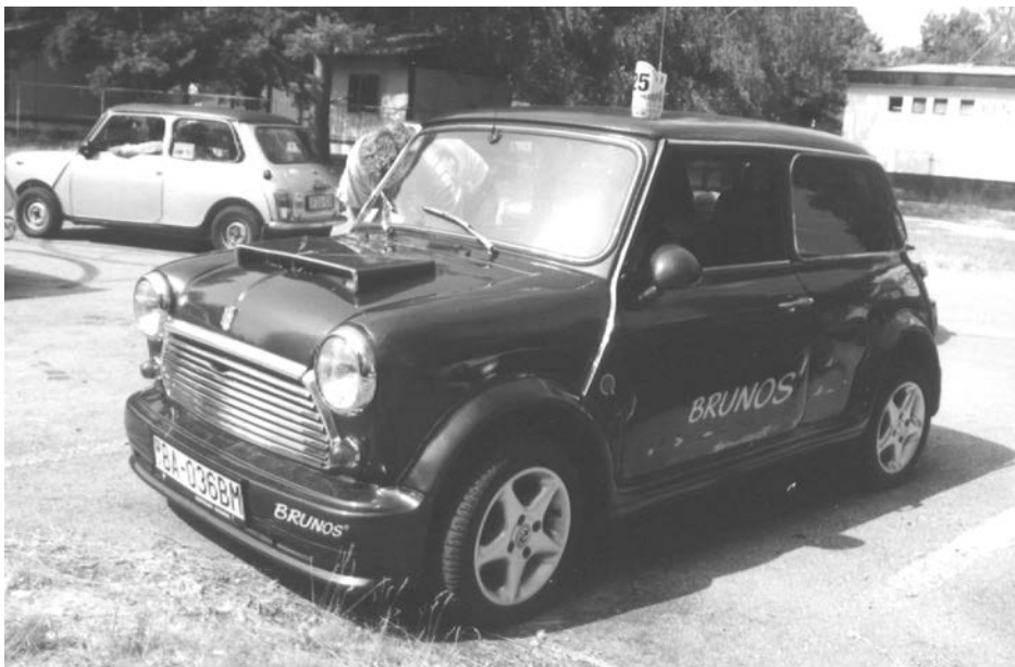
Nejnápadnější je na projektu „Brunos“ nastavená přední kapota a otvor pro těleso HS 6 karburátoru
