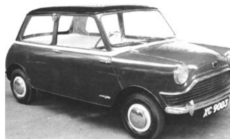
Tento Mini není úplně tím, jak vypadá – jde vlastně o dřevěnou maketu, pocházející z roku 1957, která sloužila při vývoji původního designu
