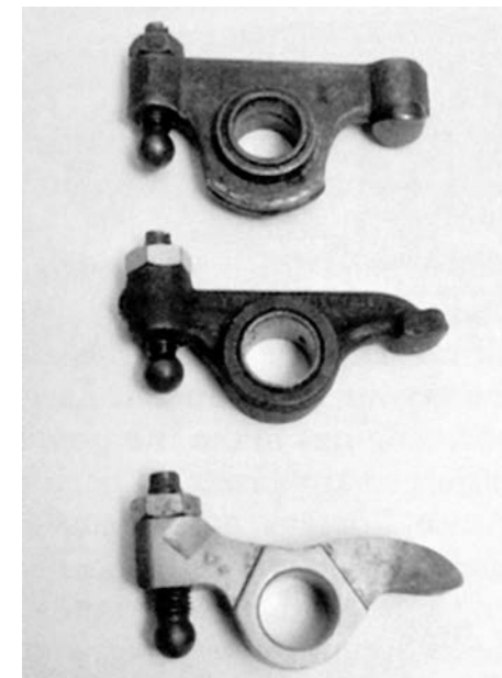
Lisované vahadlo (hore) a kované vahadlo z typu Cooper S (stred) sú pre výkon najlepšie, ale dnes sú bohužiaľ vzácné. Štandardné vahadlo vyrobené spekaním technológiou práškovej metalúrgie (dole) vám urobí tú istú službu
